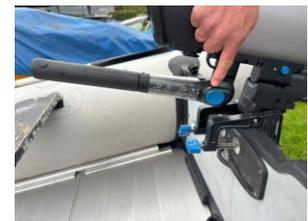
Der E-Motor wird in die Halterung gesteckt
